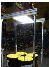
油桶防盗盖有无检测及二维码扫描系统
